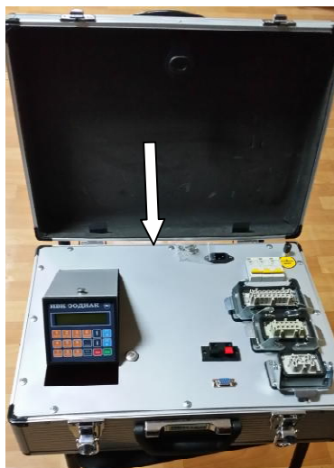
Рисунок 2 – Схема пломбировки от несанкционированного доступа, обозначение места нанесения знака поверки на лицевой части лицевой панели комплекса измерительно-вычислительного «ЗОДИАК»
