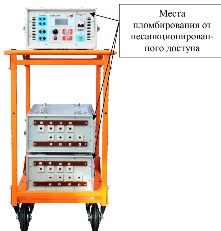
Рисунок 1 – Общий вид установок и места пломбирования от несанкционированного доступа
