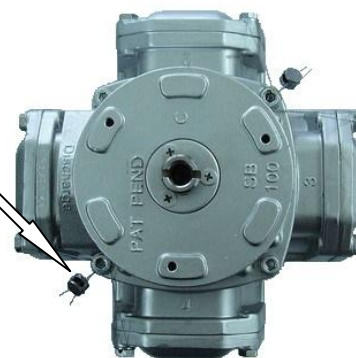
Рисунок 4 - Схема пломбировки измерителя объема
