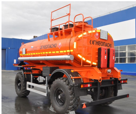
Рисунок 3 - Общий вид УЗСТ ПЦ с одной секцией
