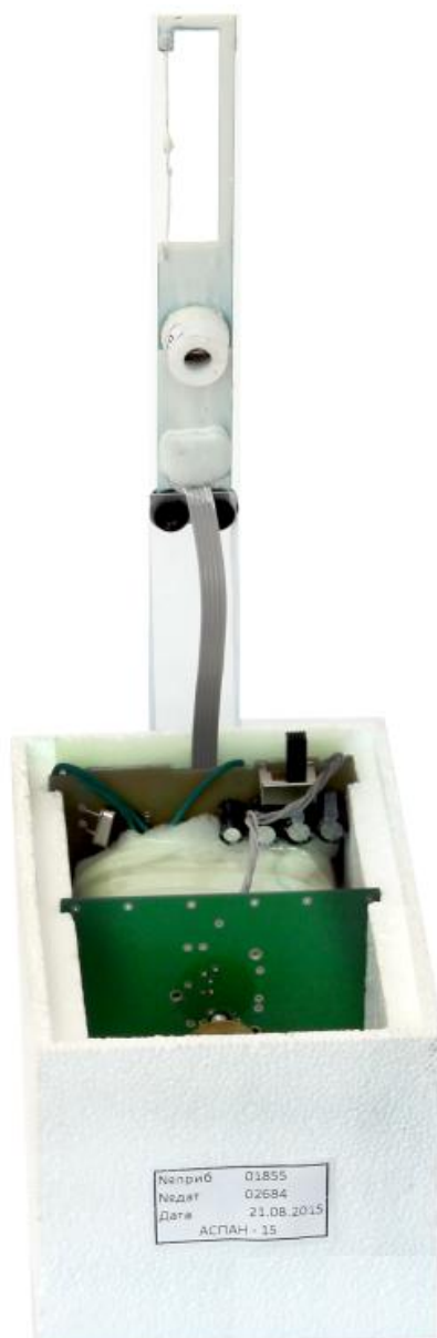
Рисунок 1 - Внешний вид радиозондов малогабаритных «Аспан-15»
