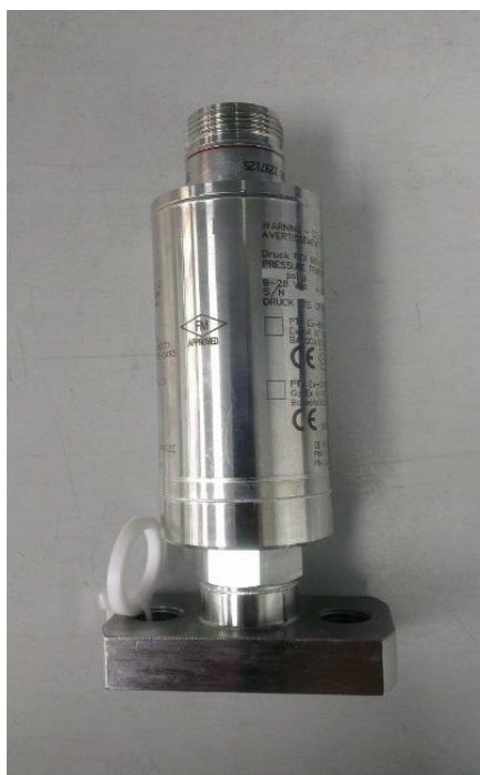
Рисунок 1 - Общий вид датчиков давления модели РТХ 661-13G-3433
