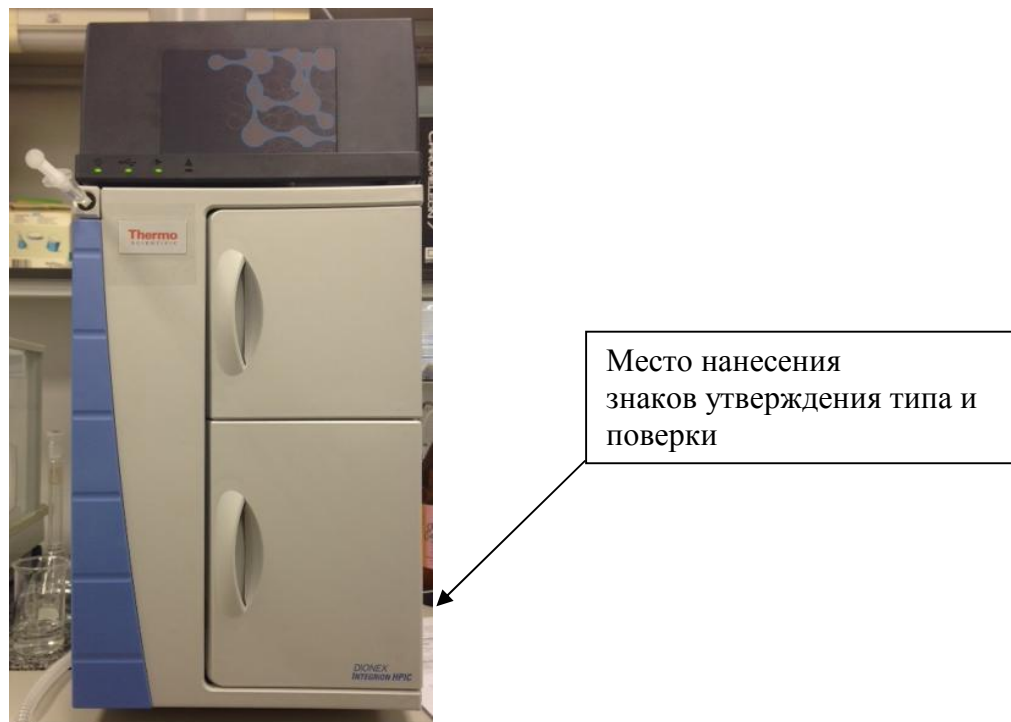
Рисунок 1 - Общий вид средства измерений Dionex Integriion Пломбирование хроматографов не предусмотрено.
