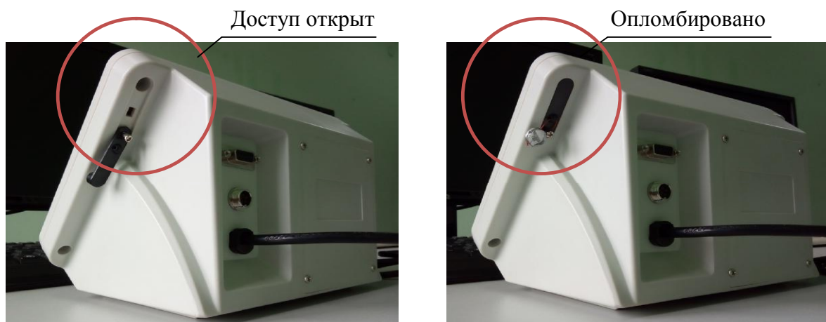
Рисунок 2 - Схема пломбировки от несанкционированного доступа
