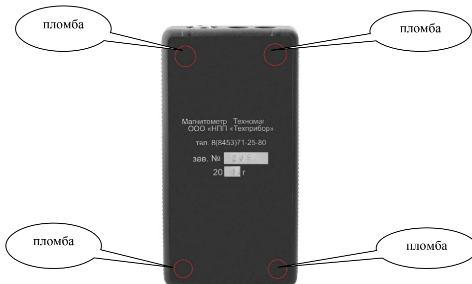
Рисунок 2 – Схема пломбировки от несанкционированного доступа
