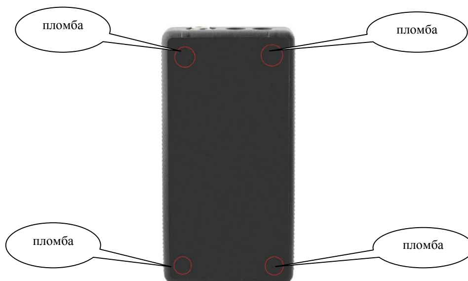
Рисунок 2 - Схема пломбировки от несанкционированного доступа
