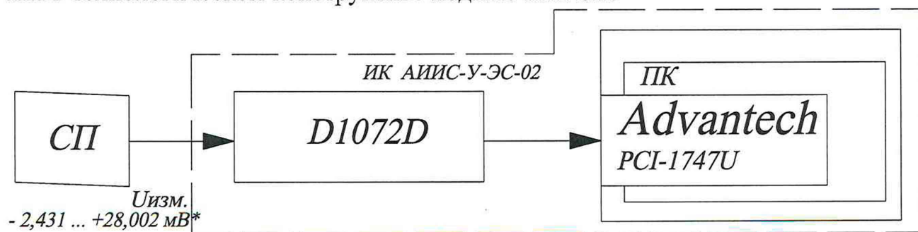
Рисунок 10.6 – Схема определения МХ ЭЧ ИК температуры газа с ПП термоэлектрического типа
