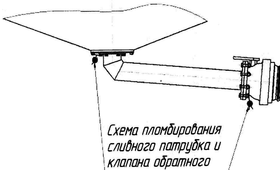
Рисунок 6 – Схема пломбирования патрубка сливного обратного клапана УПМ 100 (УПМ 500)
