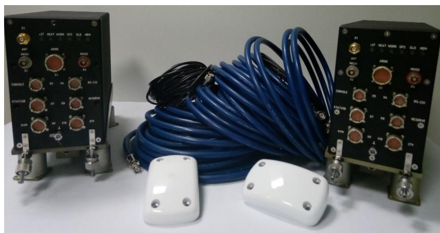
Рисунок 6 - Внешний вид измерителя координат модернизированного ИК-м1 КЕДП.466961.003
