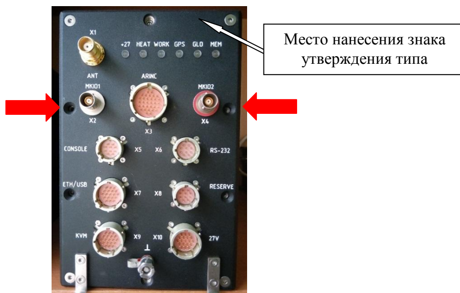
Рисунок 5 - Внешний вид лицевой панели измерителя координат модернизированного ИК-м1 КЕДП.466961.003
