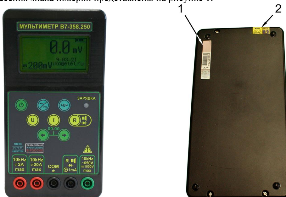
Рисунок 1 - Общий вид и схема пломбировки мультиметров
