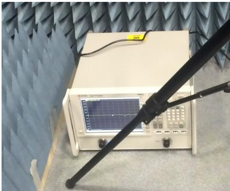
Рисунок 3 - Внешний вид ВАЦ N5232А
