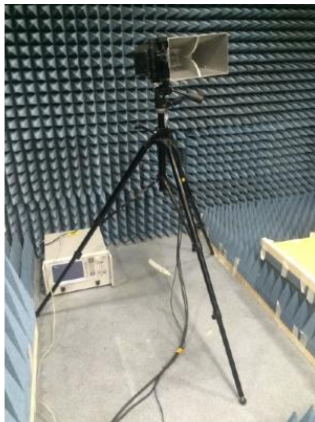
Рисунок 2 - Внешний вид ОПУ и однокоординатного поворотного устройства с установленной испытываемой и вспомогательной антенной Schwarzbeck BVNA 9120D
