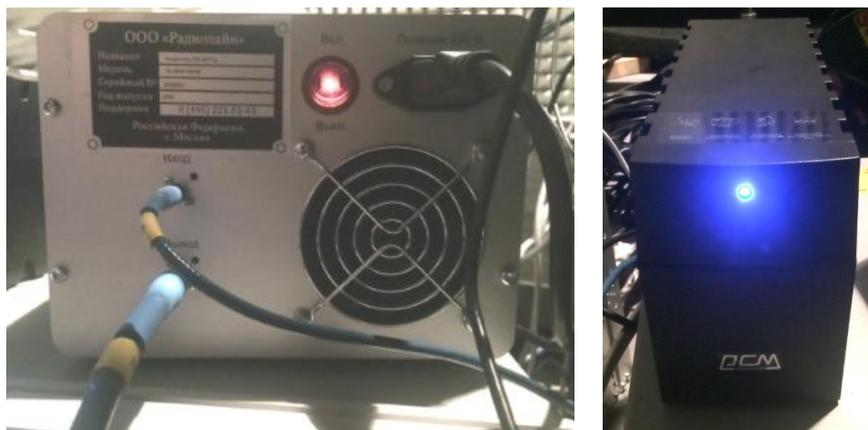
Рисунок 8 - Внешний вид маломощного усилителя (слева) и источника бесперебойного питания (справа)
