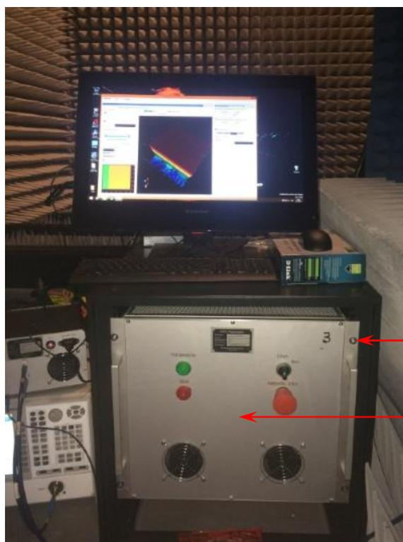
Место для пломбировки от несанкционированного доступа
