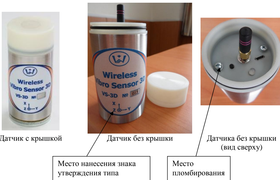
Рисунок 1 - Общий вид датчиков беспроводных трехкоординатных «VS-3D»
