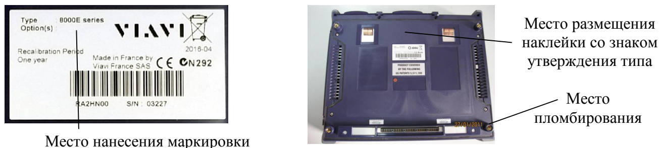
Рисунок 2 - Схема пломбировки от несанкционированного доступа, место размещения наклейки со знаком утверждения типа базового блока модификации MTS-8000E(V2)
