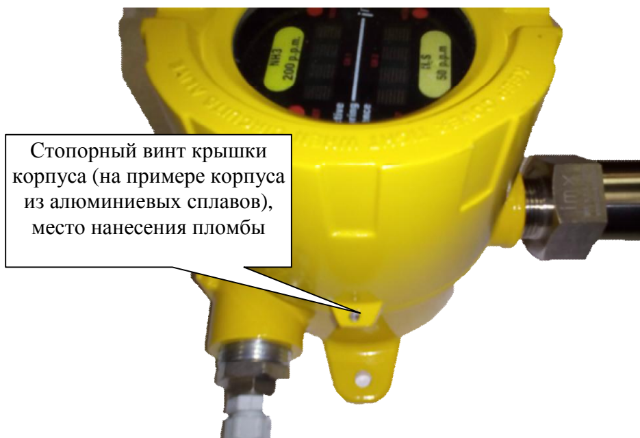
Рисунок 4 - Схема пломбировки датчиков от несанкционированного доступа
