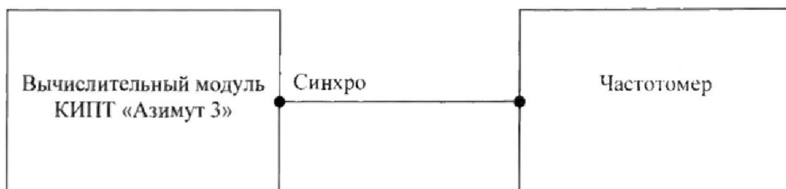
Рисунок 7 - Измерительная схема для определения погрешности следования кадровых синхроимпульсов.
