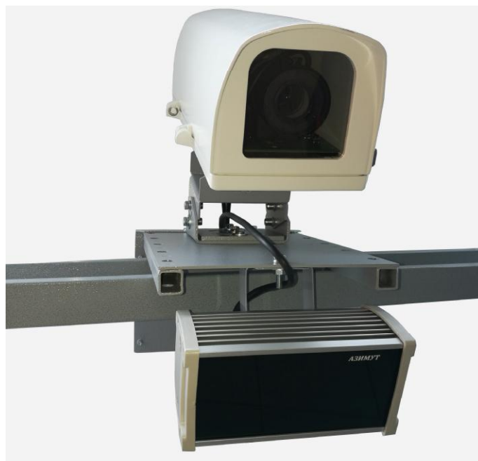
Рисунок 1 – ТВ датчик с ИК системой освещения
