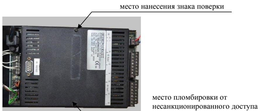
Рисунок 2 - Схема пломбировки от несанкционированного доступа, обозначение места нанесения знака поверки
