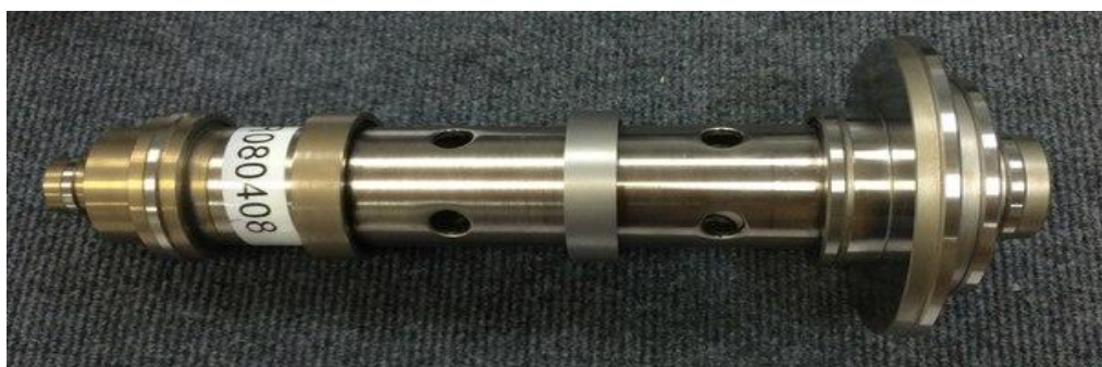
г) Мера диаметром от 25 мм до 110 мм и длиной 300 мм
