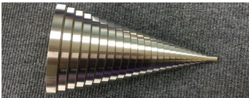
а) Мера диаметром от 10 мм до 120 мм и длиной 180 мм
