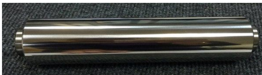
ж) Мера диаметром 50 мм и длиной 180 мм
