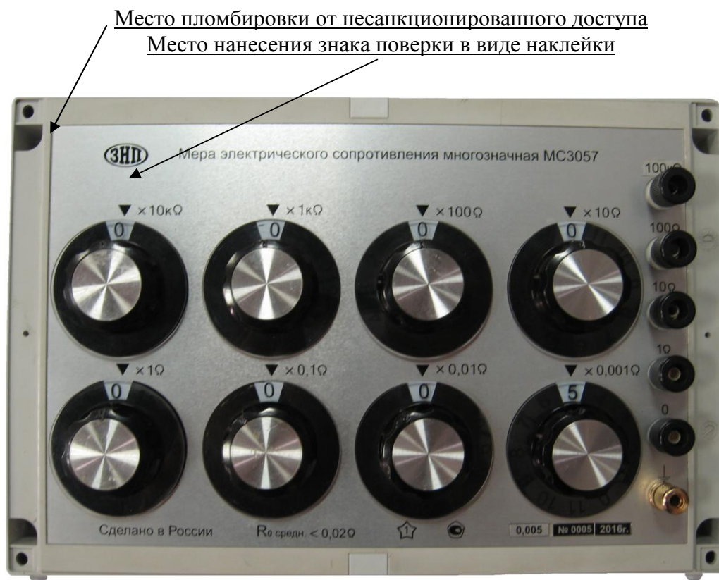
Рисунок 2 - Схема пломбировки от несанкционированного доступа, обозначение мест нанесения знаков поверки
