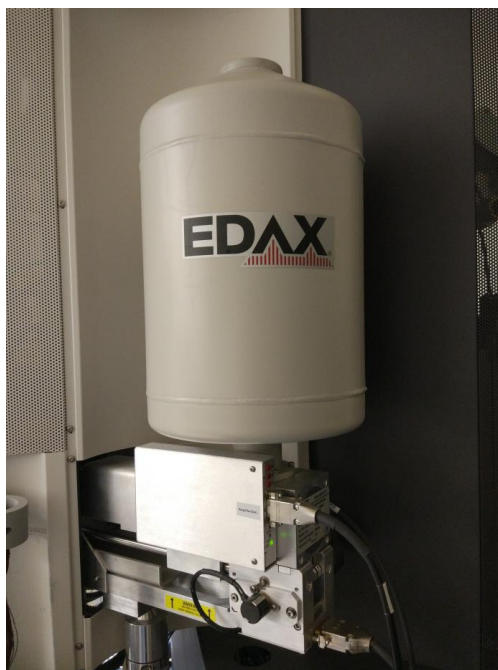
Рисунок 1 - Общий вид приставки для рентгеновской энергодисперсионной спектроскопии (EDXS) Retractable EDS Detector 300 kV (S-)TWIN TITAN 300 ST 136 5
