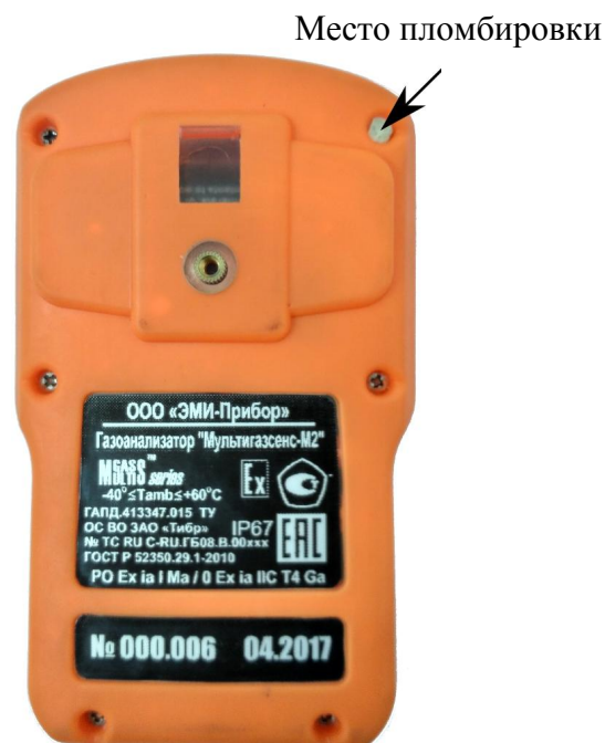
Рисунок 2 - Схема пломбировки от несанкционированного доступа МУЛЬТИГАЗСЕНС-М2
