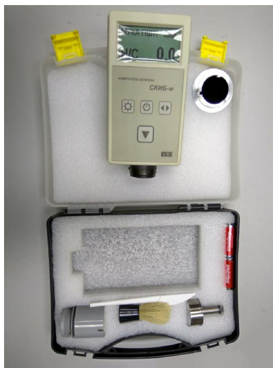
Рисунок 1 - Общий вид прибора для определения белизны муки СКИБ-М
