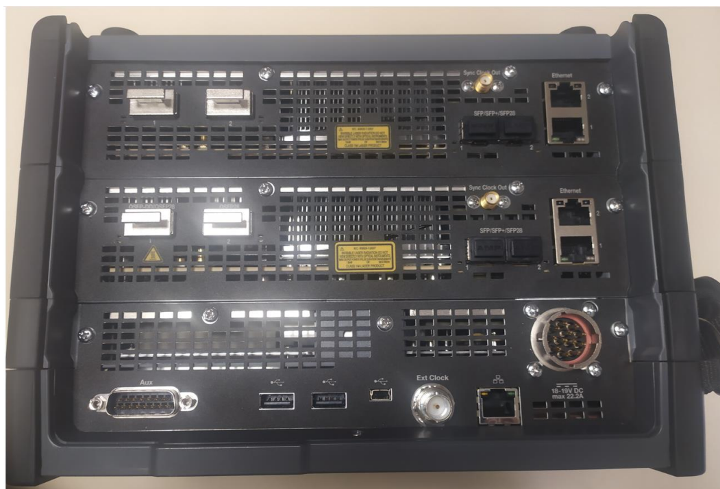
Рисунок 2 - Вид верхней панели анализатора с модулями MU104011A и MU104014A
