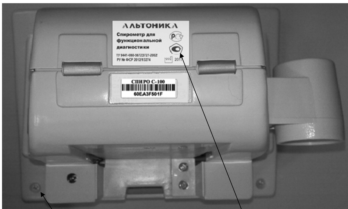
Рисунок 2 - Обозначение места нанесения Знака утверждения типа и места пломбировки от несанкционированного доступа на спирометре производства ООО «Альтомедика»
