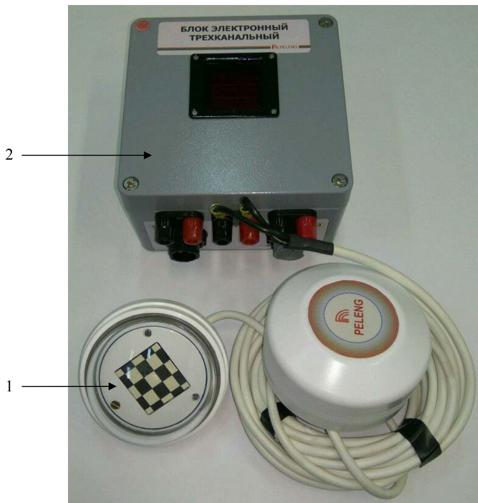
Рисунок 1 - Общий вид пиранометров «Пеленг СФ-06» 1 - головка пиранометра, 2 - блок электронный трехканальный
