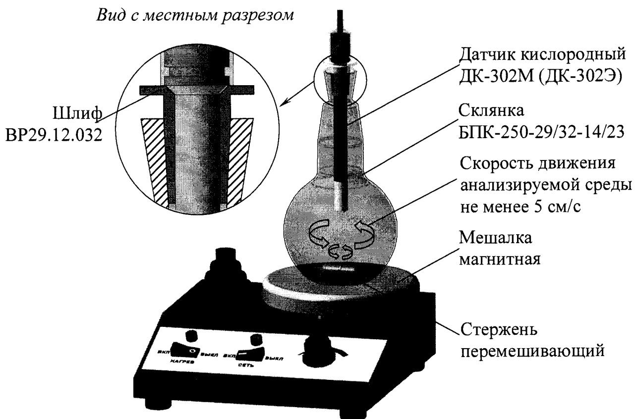
Рисунок 2.36 – Положение датчика ДК-302М (ДК-302Э) в склянке при измерении БПК
