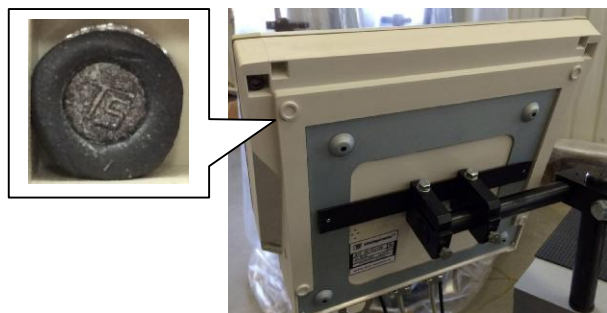
а) пломбировка в виде клейма
