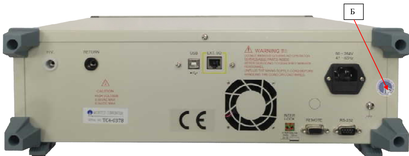
Рисунок 2 - Схема пломбировки от несанкционированного доступа (Б)
