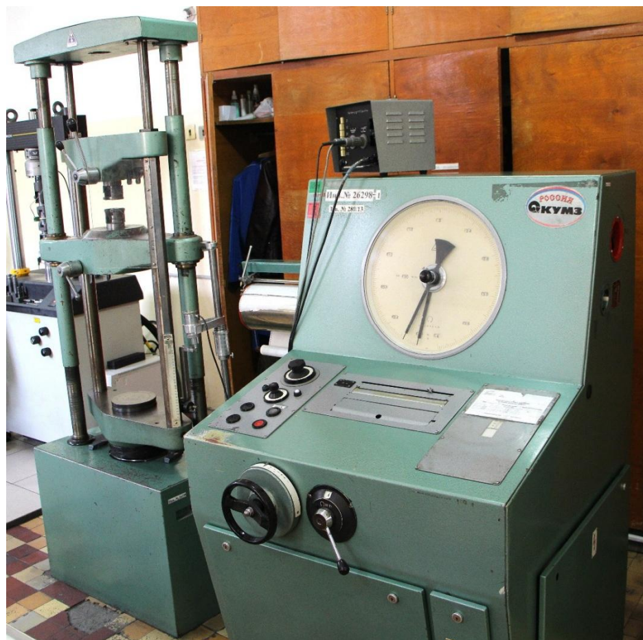
Рисунок 1 - Общий вид машины испытательной ZD 10
