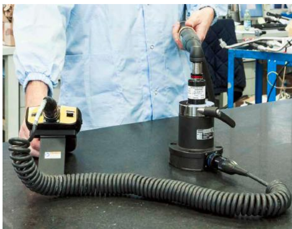
Рисунок 1 - Общий вид измерителей крутящего момента силы SRTT-B 10 - 13, SRTT 2500, SRTT 16000
