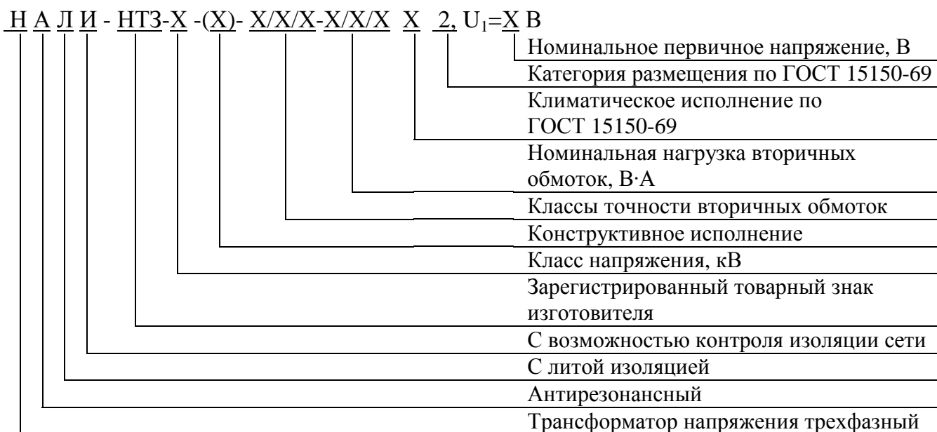
Рисунок 3 - Структура условного обозначения трансформаторов напряжения НАЛИ-НТЗ
