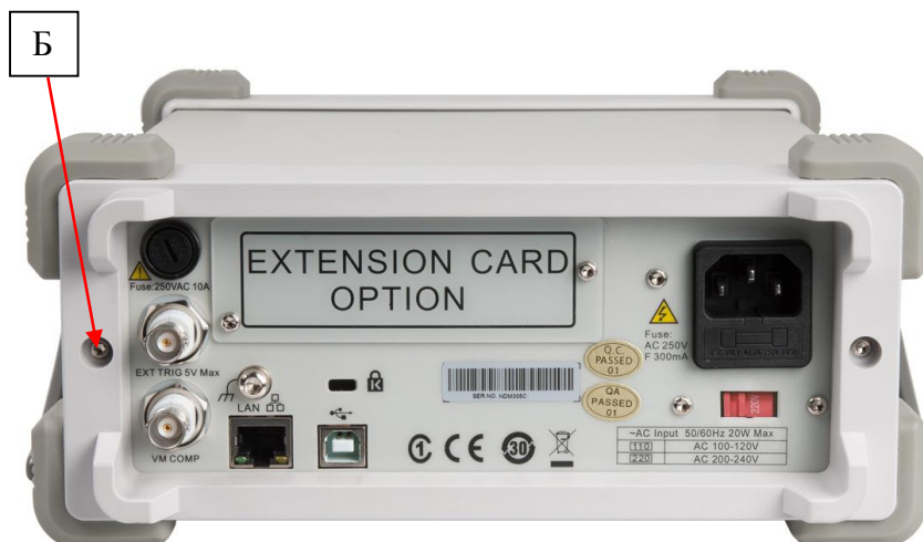
Рисунок 2 - Схема пломбировки от несанкционированного доступа (Б)
