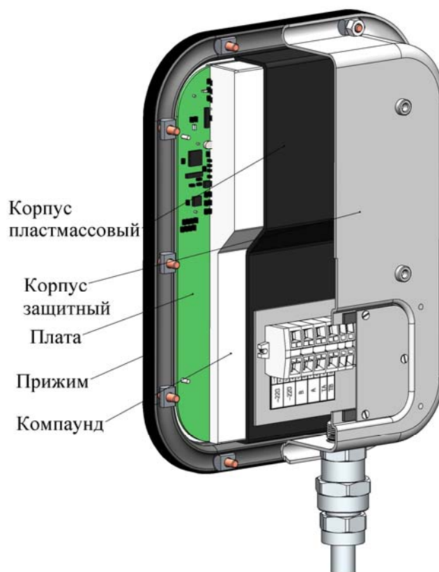
Рисунок 9 - Схема пломбировки БУИ от несанкционированного доступа
