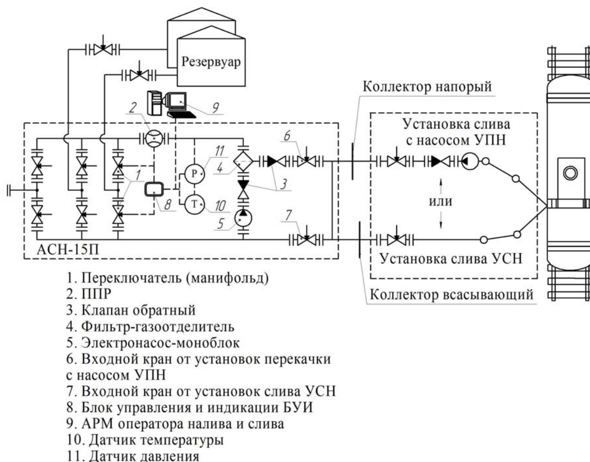
Рисунок 7 - Система измерительная для приёмки и перекачки продукта от ЖД цистерн в резервуары и между резервуарами АСН-15П. Измерительная схема
