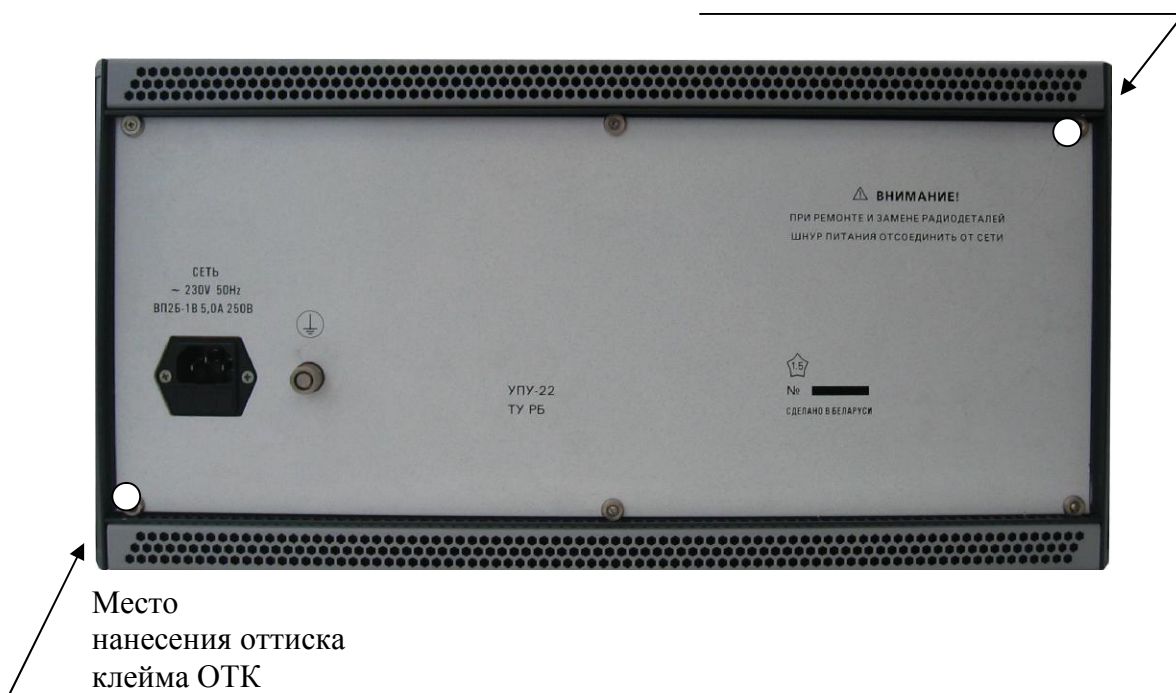
Рисунок 2 - Место нанесения знака поверки и оттиска клейма ОТК (вид установки сзади)
