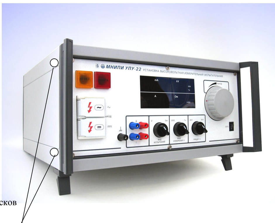
Рисунок 3 - Место нанесения оттисков клейм ОТК (вид установки с левого бока)
