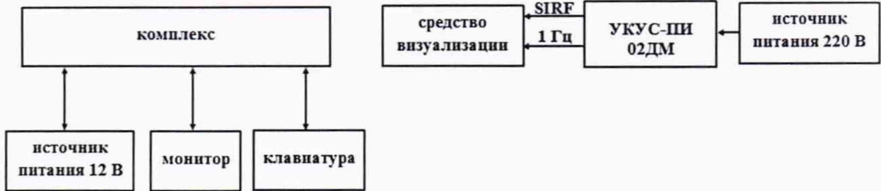
Рисунок 1 - Схема проведения измерений при определении погрешности синхронизации шкалы времени
