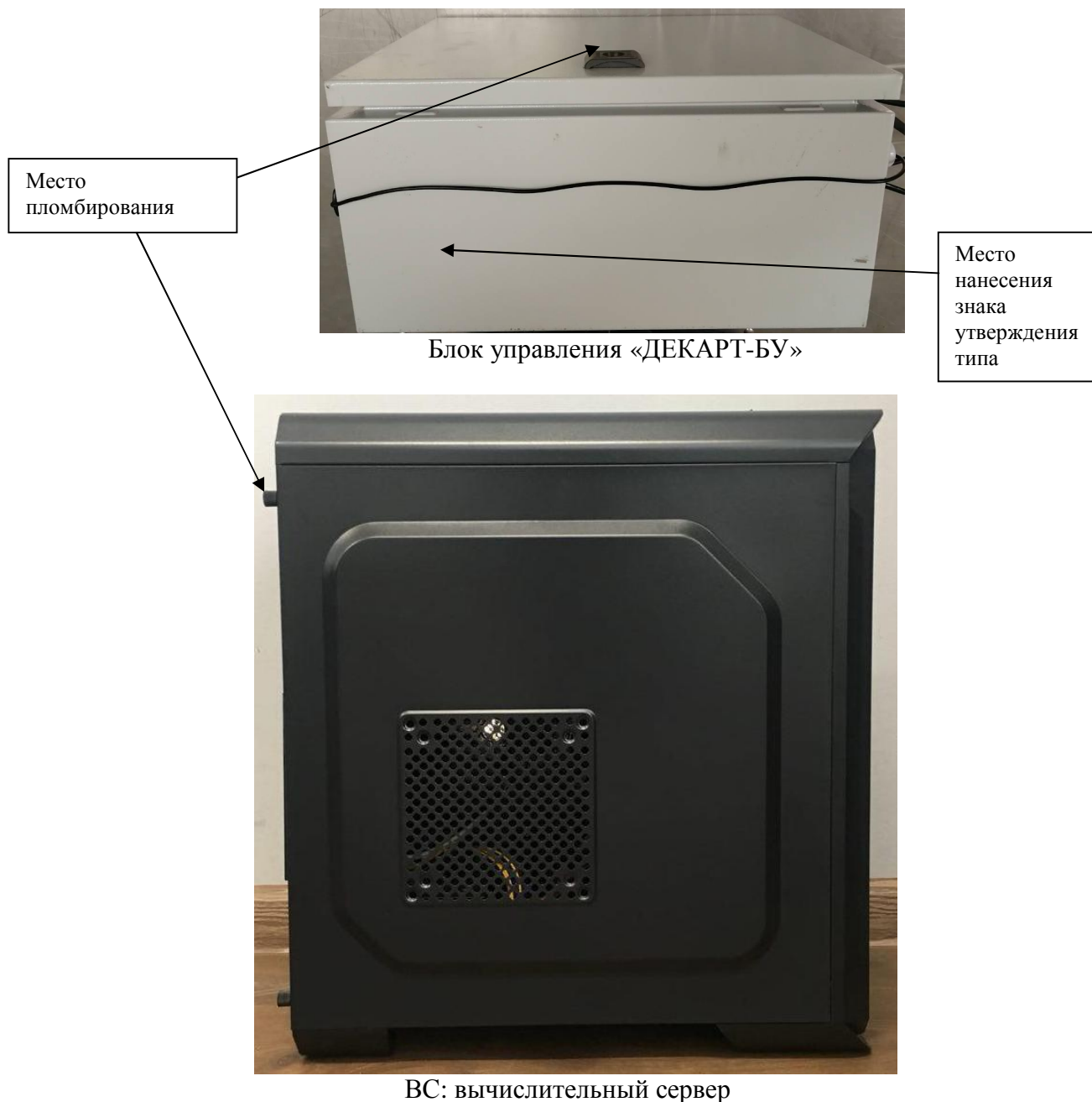
Рисунок 2 - Место пломбирования от несанкционированного доступа и место нанесения знака утверждения типа
