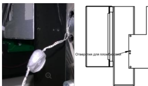
Рисунок 3 - Схема пломбировки от несанкционированного доступа крышки ЭЦБ «Шельф», обозначение места нанесения знака поверки
