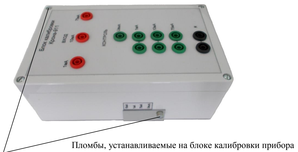
Рисунок 2 - Общий вид блока калибровки «Крона-911» и схема его пломбирования от несанкционированного доступа
