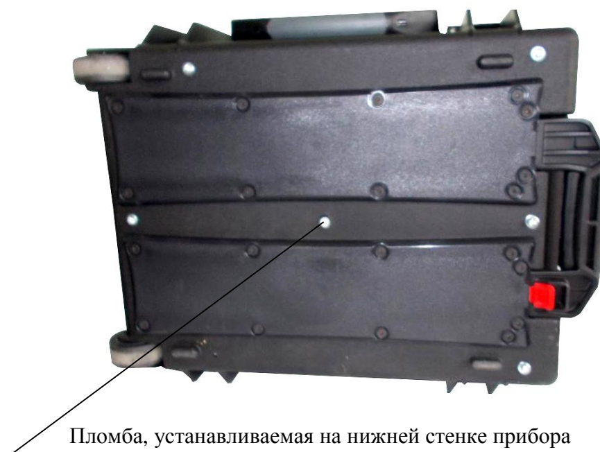
Рисунок 1 - Общий вид прибора контроля роторных диодов «Крона-911», место нанесения на него знака утверждения типа средства измерений и схема пломбирования от несанкционированного доступа
