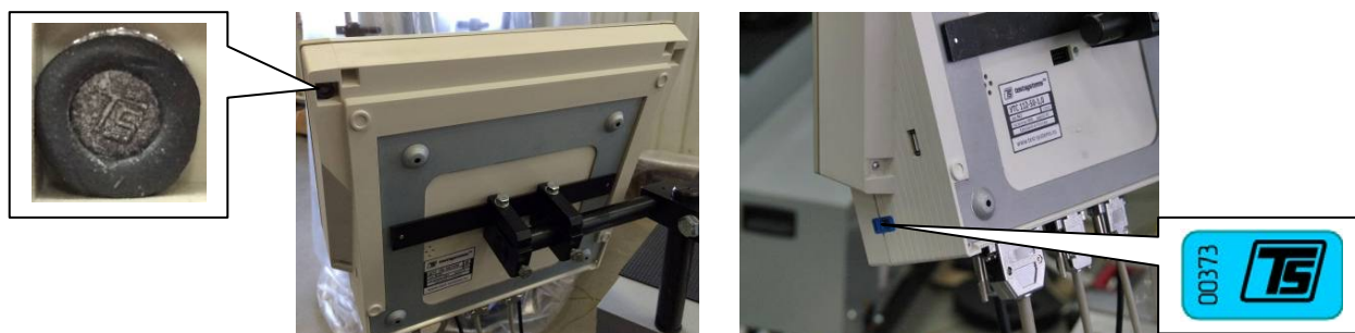
а) пломбировка в виде клейма б) пломбировка наклейкой
