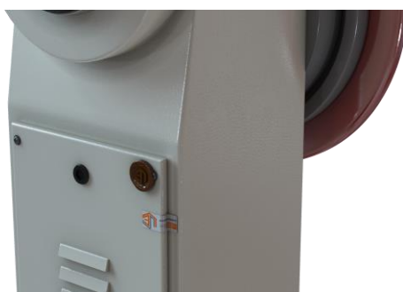
Рисунок 6 - Схема пломбировки копров РКМ-К 300 (450, 500, 800).1.1 (2).1 (2, 3) от несанкционированного доступа
