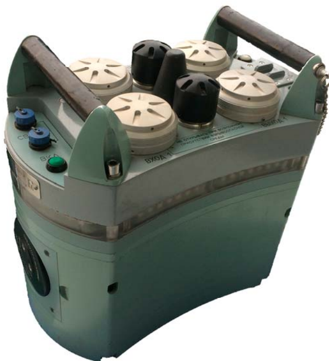
Рисунок 1 - Общий вид газоанализаторов
