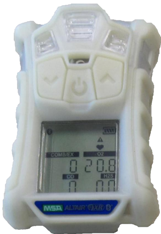
а) версия с фосфоресцирующим корпусом
