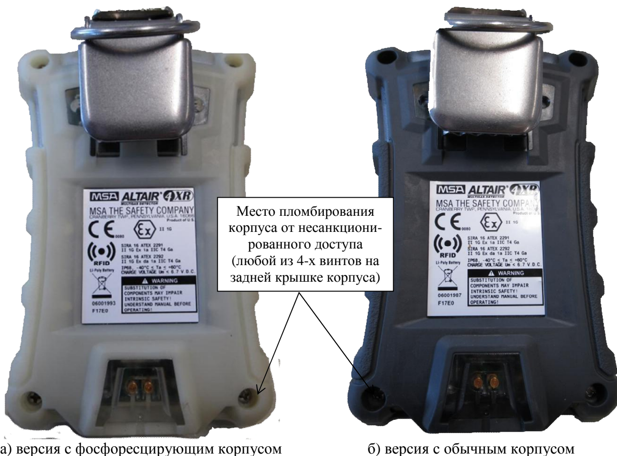
Рисунок 2 - Схема пломбировки корпуса газоанализаторов от несанкционированного доступа
