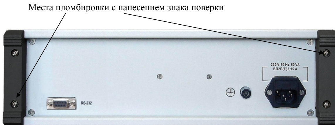
Рисунок 2 - Схема пломбировки от несанкционированного доступа, обозначение мест нанесения знака поверки
