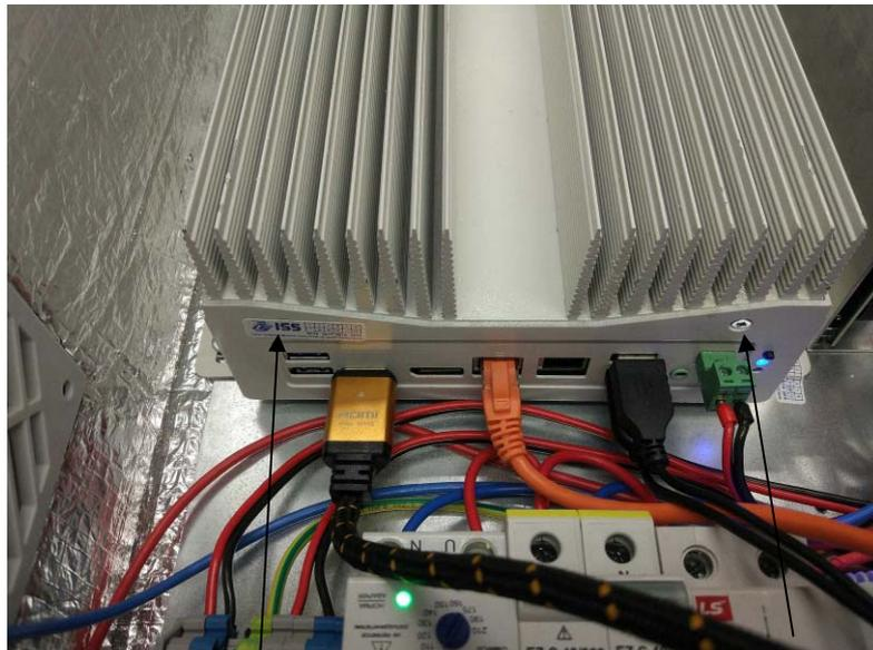
Рисунок 2 - Место пломбирования комплексов
