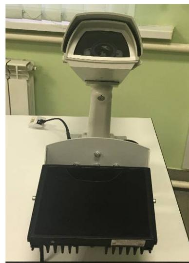
Рисунок 4 - Внешний вид обзорной/распознающей камеры SecurOS IVS AutoCam-IP Full с установленным ИК- прожектором DL252-850-15
