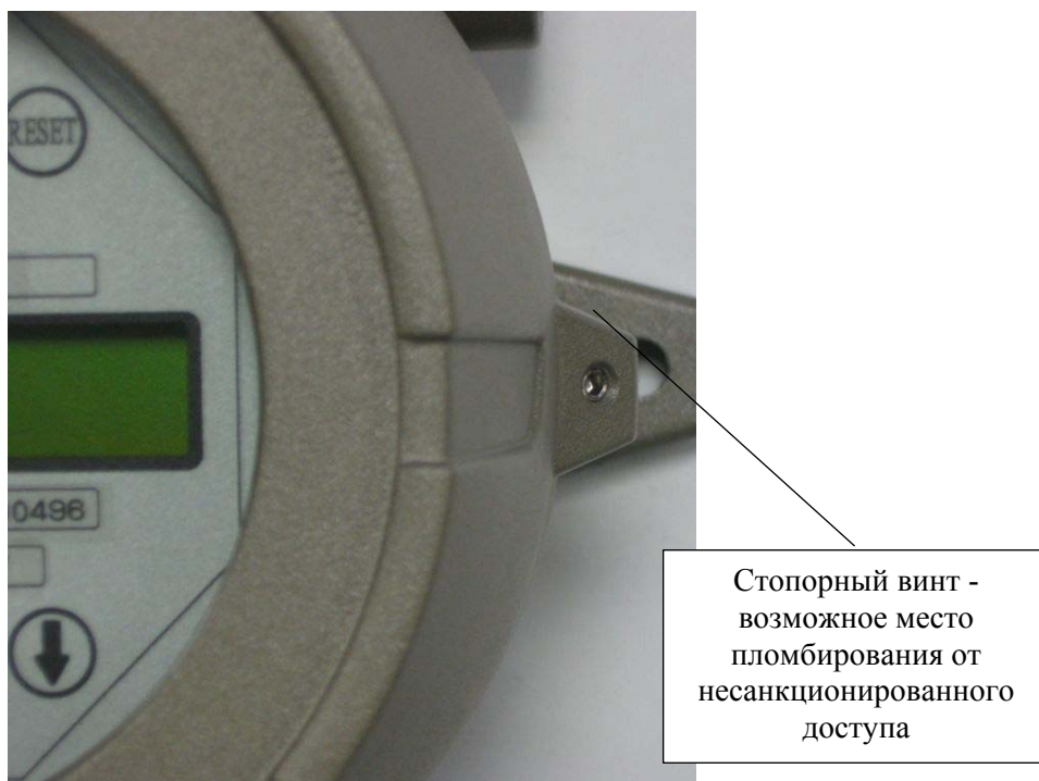
Рисунок 2 - Схема пломбирования газоанализаторов (на примере GIR-3000)
